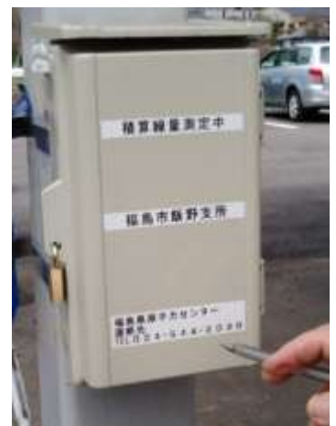
駐車場に設置された線量計。以前はケースがなく計測値が見られたそうだが、いまは嚴重に鍵が掛けられている。
